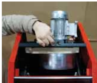
Ventilador con motor en posición vertical | Vertical intaking fan
